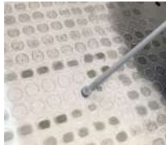
Шаг 2: Нанесение колонии тонким слоем круговыми движениями от центра к периферии на стальную подложку, высушивание
